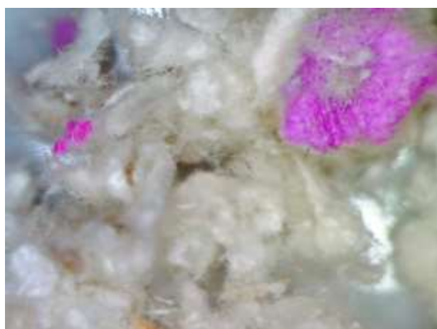
Рис.1. Сорбент ТМ под микроскопом
