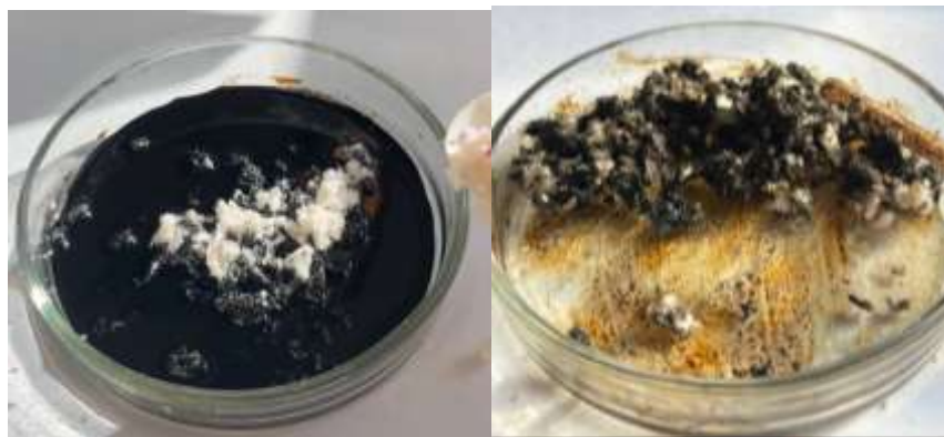
Рис.2. Проверка нефтеемкости сорбента ТМ Ecollose i-sorb
