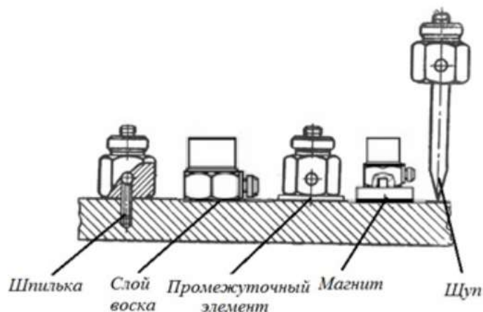
Рис. 1. Способы крепления датчиков
