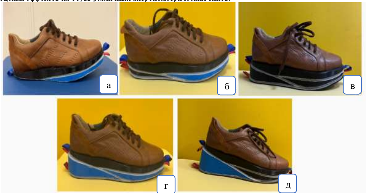
Рис.1. Система для индивидуального подбора конфигурации низа обуви: а – каблук 1.5 см; б – каблук 2.5 см; в – каблук 3 см; г – каблук 4.5 см; д – каблук 5.5 см.
