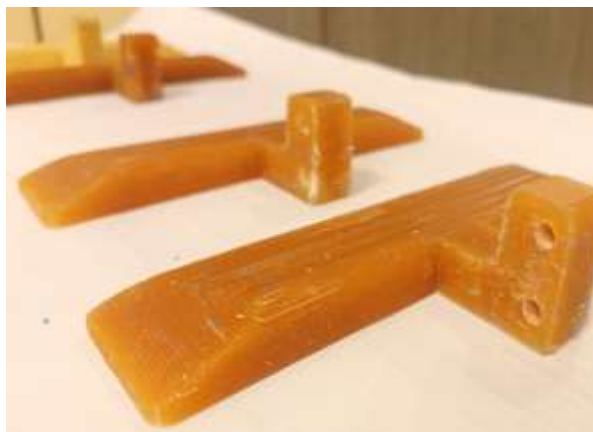
Рис. 3. Лопатка конвейера после изготовления из древесно-полимерного композита двухэкструдерным 3D-принтером
