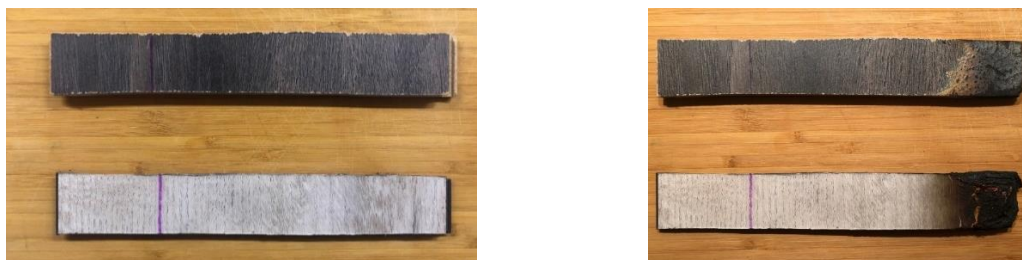
Рис.5. Образцы ламината и плитки ПВХ до и после испытаний.
