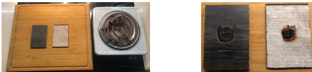
Рис.4. Ход эксперимента и образцы ламината и плитки ПВХ после испытаний.
