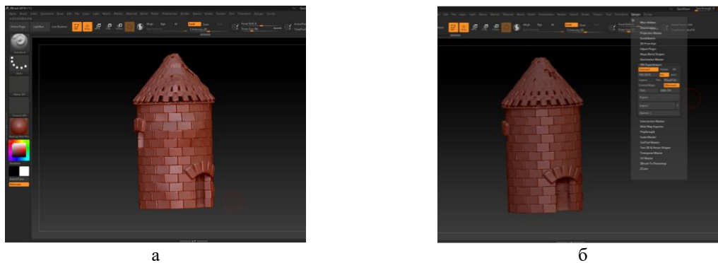
Рис.5. Модель башни в ZBrush: а – из файла формата *.obj; б – из файла формата *.fbx
