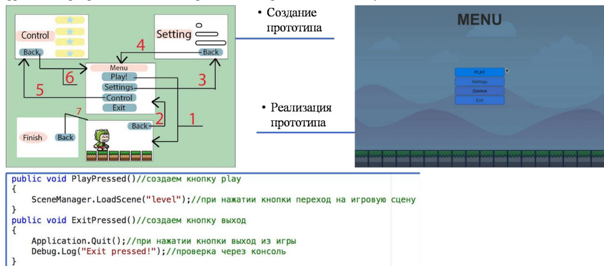
Рис. 4. Прототип интерфейса оболочки и фрагмент программного кода его реализации
